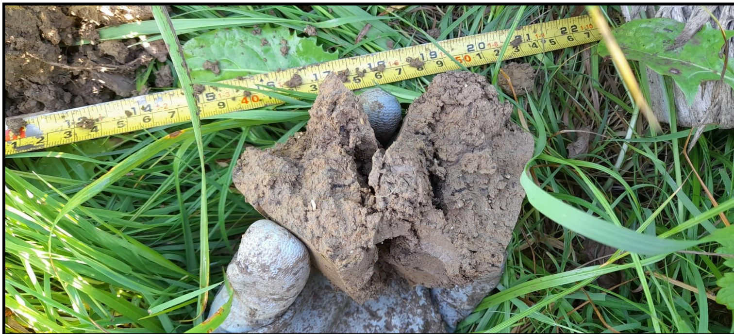
Figure n°44 : photo du quinzième point de sondage 23.08.2023 – zoom la carotte 40 - 50 cm – F.K.
